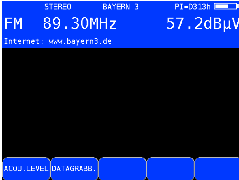
VHF stereo indicator display
